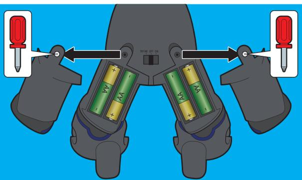
**CZ** **VÝMĚNA BATERIÍ - NÁVOD:** Výměnu baterií smí provádět pouze dospělá osoba. Postupujte dle obrázku (dodržujte správnou polaritu). Odšroubujte kryt úložného prostoru pro baterie. Výrobek vyžaduje 4 x AA baterie (výrobek obsahuje baterie určenou pouze k vyzkoušení výrobku). Doporučují se alkalické baterie.
